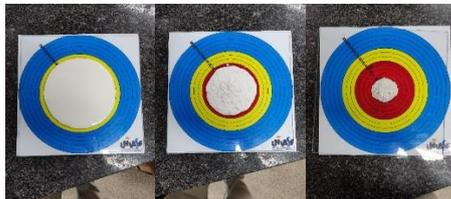
Figura 4. Ensaio de consistência para proporção 0.6
