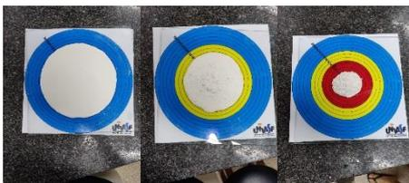
Figura 5. Ensaio de consistência para proporção 0.7
