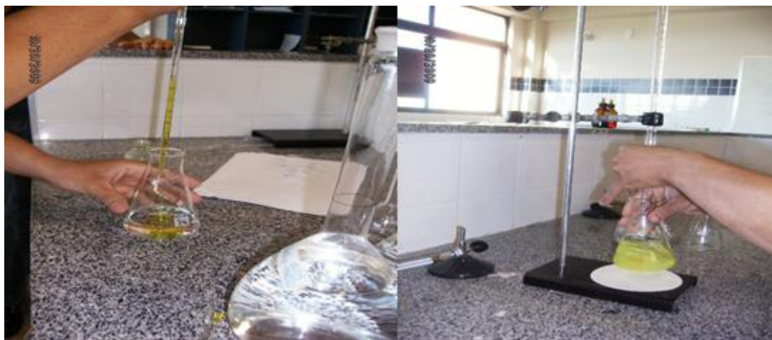
Figura 3 – Adição de cromato de potássio em solução de cloreto de sódio e adição de nitrato de prata em solução de cloreto de sódio com cromato de potássio.
