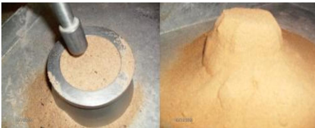
Figura 2 - Socamento da areia e condição saturada de superfície seca após a retirada do molde.
