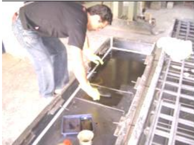
Figura 07 – Aplicação de desmoldante. Figura 08 – Fôrma pronta para concretagem.
