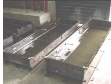
Figura 07 – Aplicação de desmoldante. Figura 08 – Fôrma pronta para concretagem.
