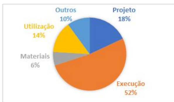
Figura 1. Gráfico de incidência das origens das manifestações patológicas na construção civil no Brasil (Adaptado de Oliveira, 2013).
