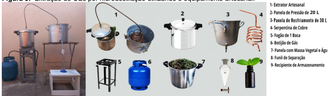
Figura 8: Extração de OEs por hidrodestilação utilizando o equipamento artesanal.
