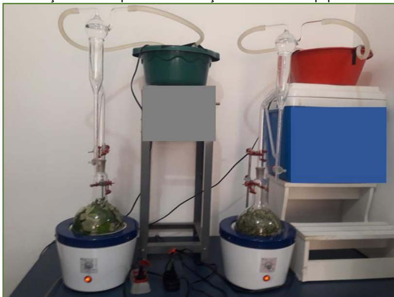
Figura 7: Extração de OEs por hidrodestilação utilizando o equipamento Clevenger.
