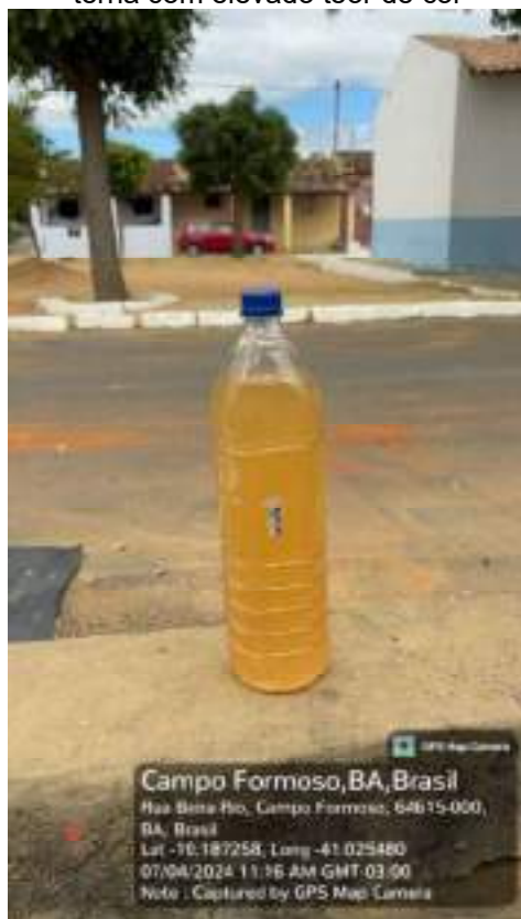
Figura 51 — Água armazenada na cisterna com elevado teor de cor
