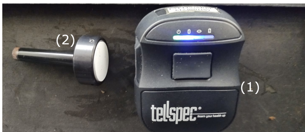
Figura 7 – Configuração utilizada durante a aquisição dos dados com o Telspec Enterprise Sensor. Como as lâmpadas já são integradas ao sistema, é necessário apenas aproximar o espectrômetro (1) da amostra. Um anteparo reflexivo de cor branca (2) é posicionado atrás da amostra com o objetivo de amenizar o efeito de transmitância através do líquido.
