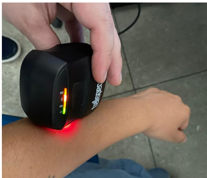
Figura 6 – Dispositivo DLP NIRscan Nano realizado a coleta da espectroscopia.
