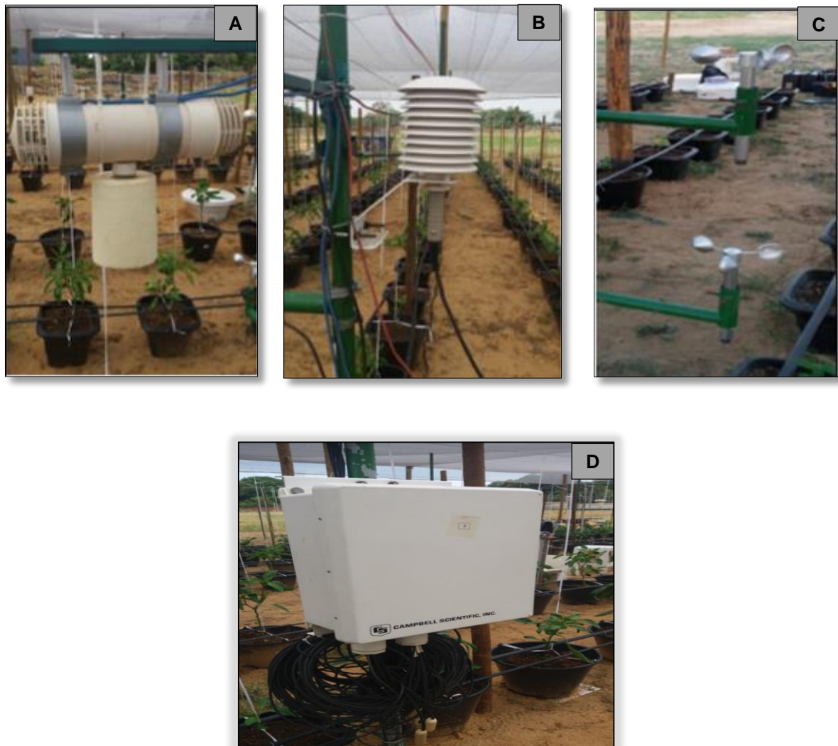
Figura 4. Psicrômetro (A, B), anemômetros a 1 e 2 m de altura (C) e sistema de aquisição de dados (D).
