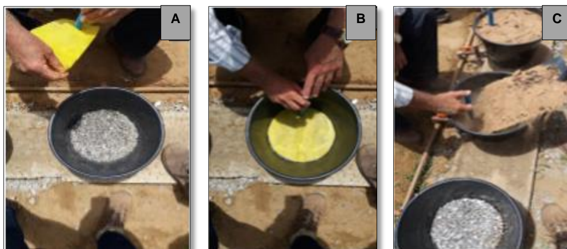
Figura 5. Preenchimento dos lisímetros: camada de brita (A), TNT(B) e mistura de solo e esterco caprino(C).
