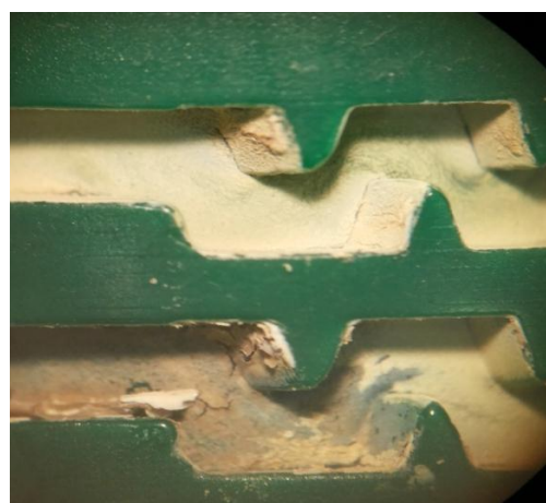
Figura 03. Visualização interna do labirinto dos emissores NC1 (A) e NC2 (B)
