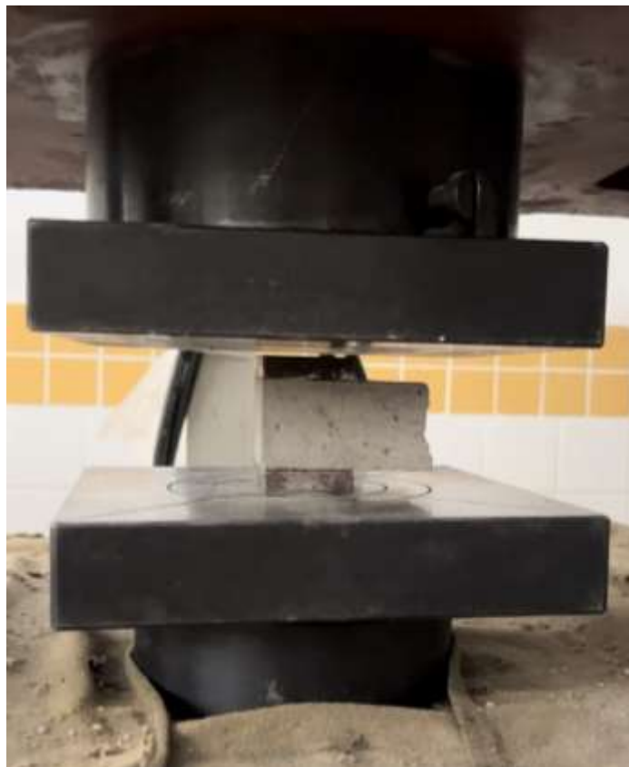
Figura 14 – Realização do ensaio de resistência à compressão axial simples.
