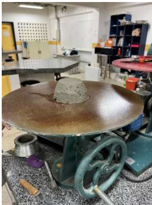
Figura 11 – Ensaio para obtenção do Índice de Consistência.
