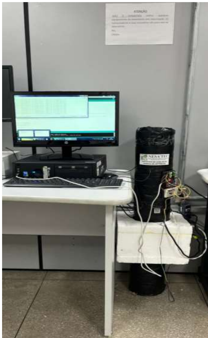
Figura 17 – Protótipo de avaliação térmica de materiais.
