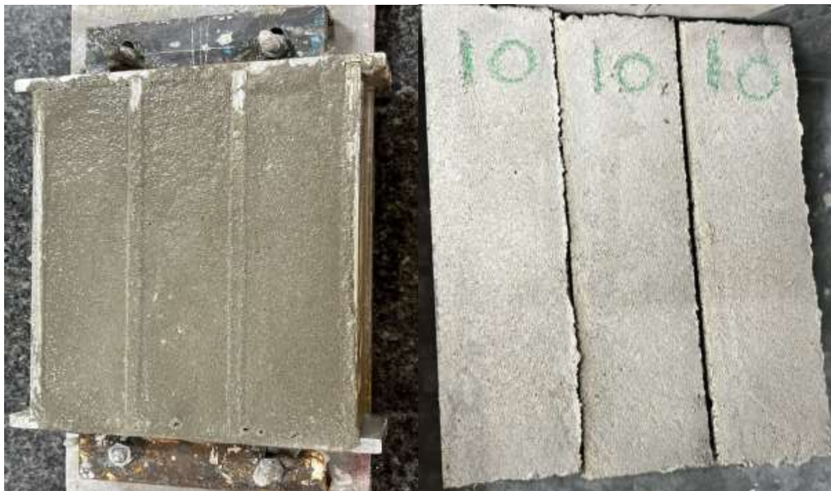
Figura 12 – Modelagem dos corpos de prova para realização do ensaio na tração na flexão.
