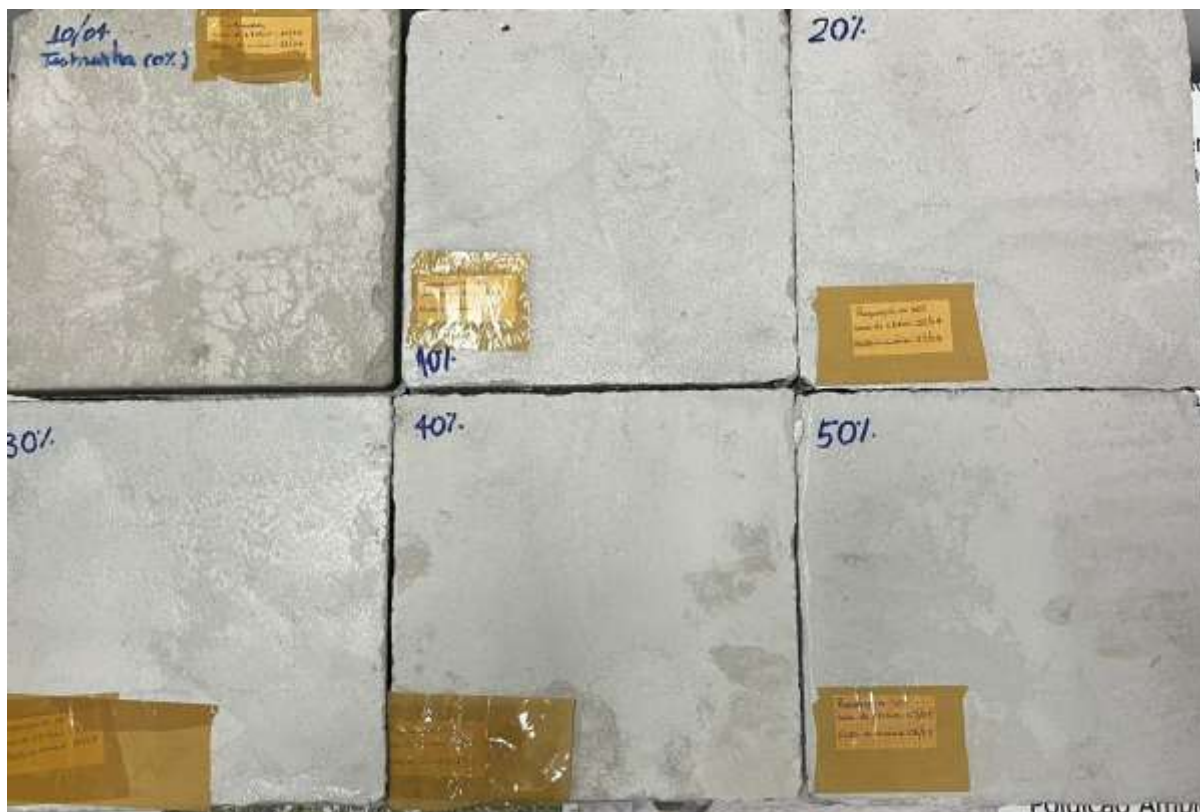
Figura 16 – Corpos de prova para análise de avaliação de térmica.
