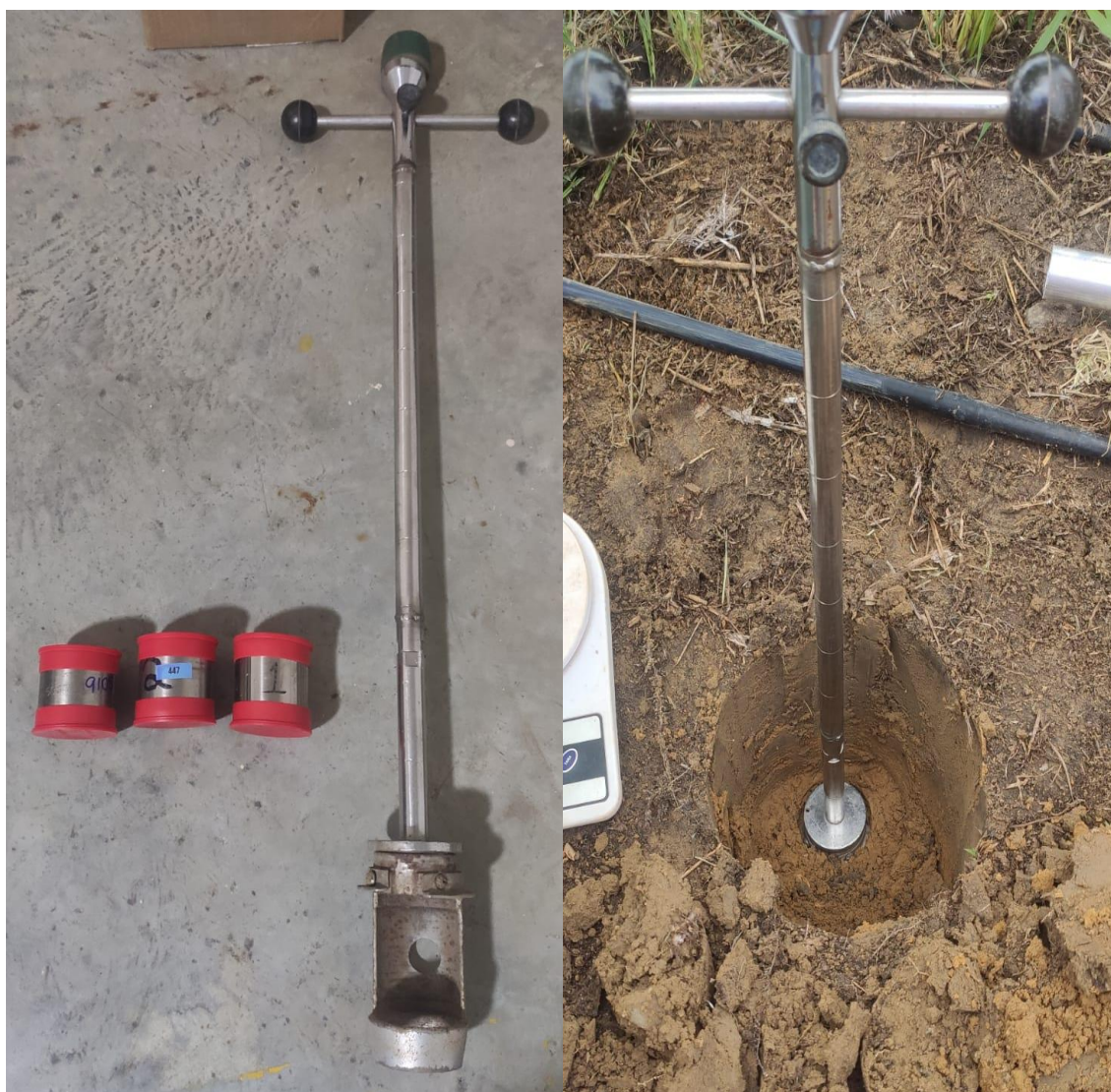
Figura 1. Trado e cilindros utilizados para a coleta das amostras de solo.
