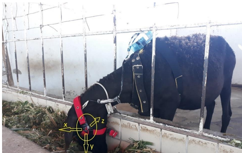
Figura 8 – Protótipo testado no animal e direção dos eixos X, Y e Z do ADXL345.
