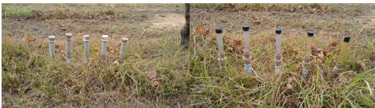
Figura 2: Bateria de tensiômetros para determinação do potencial matricial da água no solo nas profundidades de 0,2 m, 0,4 m, 0,6 m, 0,8 m e 1,0 m.
