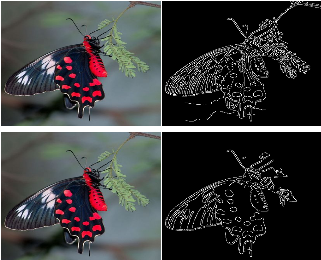
Figura 21: Detecção de borda com Threshold de 0.85 (superior) e 0.93 (inferior).
