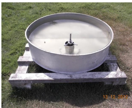
Figura 3 - Tanque Classe A sobre lastro de madeira e seu poço tranquilizador na Estação Meteorológica do Campus III da UNEB, em Juazeiro, BA.
