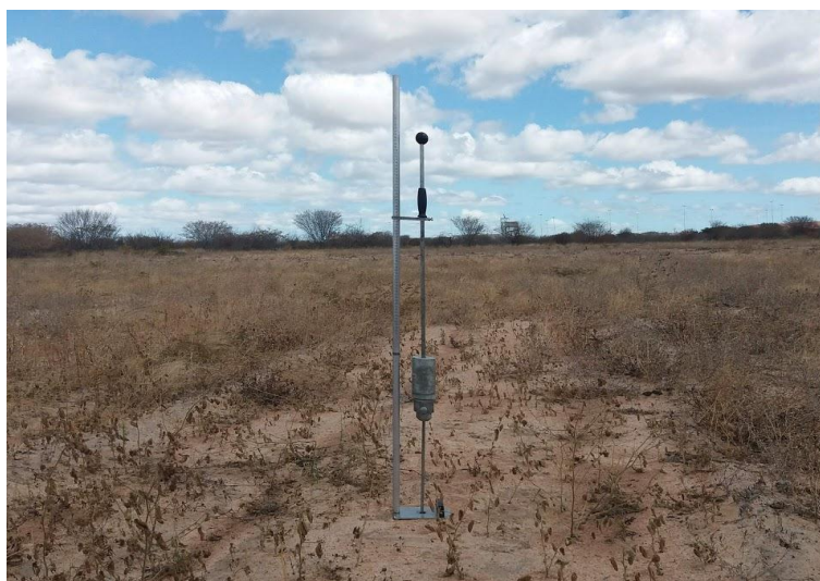
Figura 3. Penetrômetro de impacto, modelo IAA/Planalsucar-Stolf, utilizado na caracterização da área experimental.
