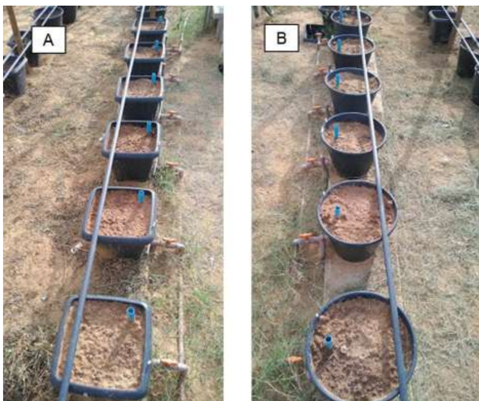
Figura 5. Conjuntos de lisímetros de lençol freático constante para vasos quadrados (A) e vasos circulares (B).
