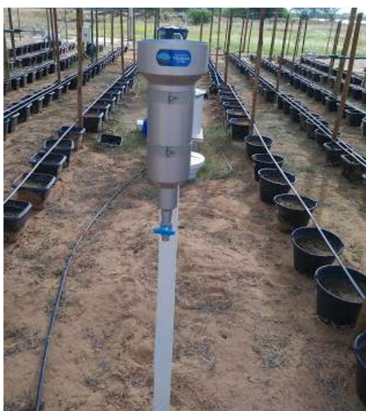
Figura 9. Pluviômetro Vilas Boas instalado na área experimental.
