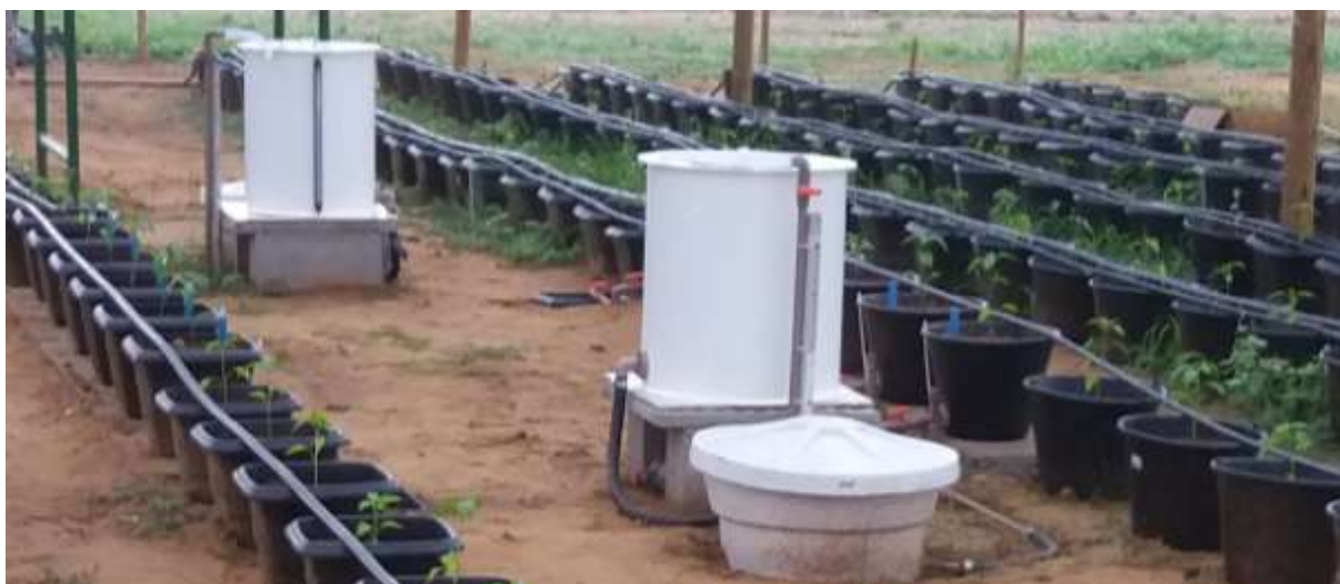
Figura 8. Vista dos lisímetros instalados na área experimental.
