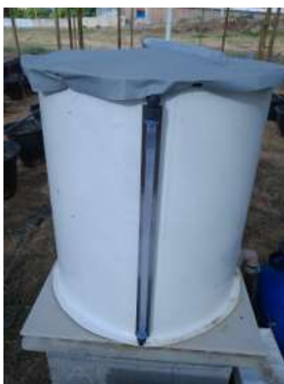
Figura 7. Reservatório de suprimento com detalhe da escala de leitura, em milímetros.
