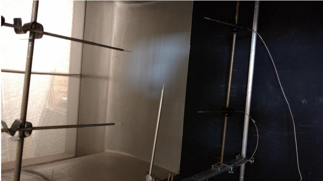
**Figura 6:** Calibração dos anemômetros
