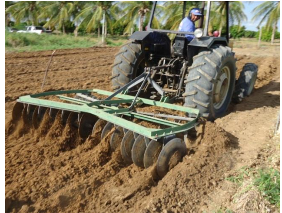
Trator Valtra 785 TDA durante Gradagem Niveladora.
