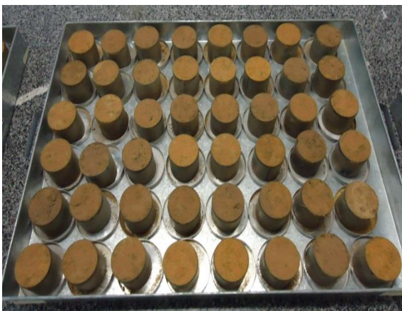
Amostras para determinação de Ds e Pt.
