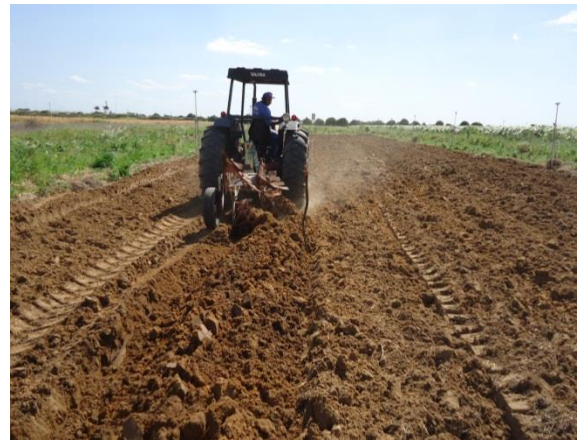
Trator Valtra 785 TDA durante preparo do solo com Arado Aivecas.
