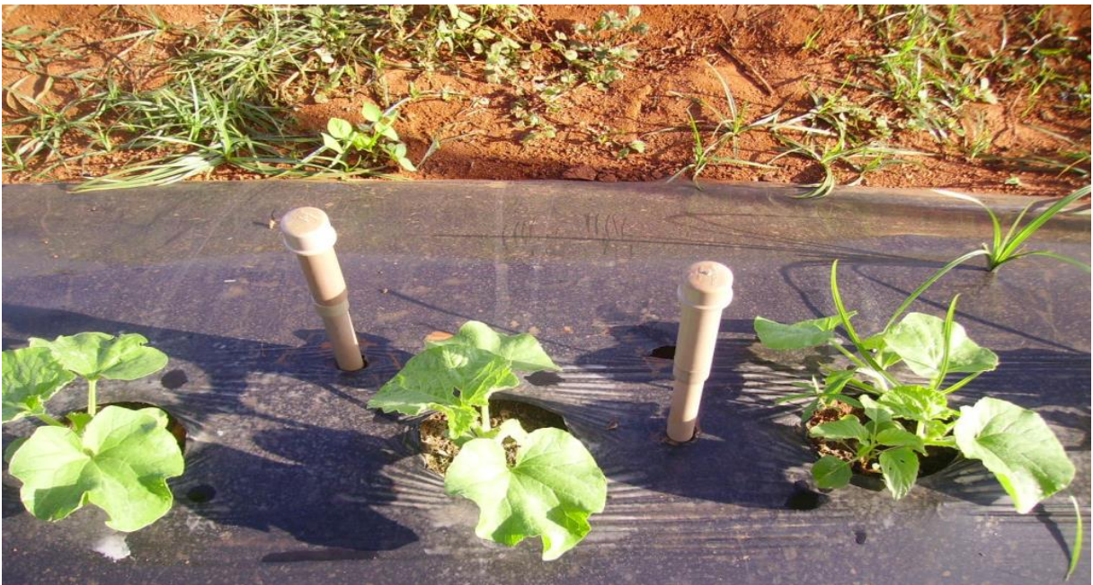
Figura 4: Instalação dos tensiômetros dentro da parcela experimental
