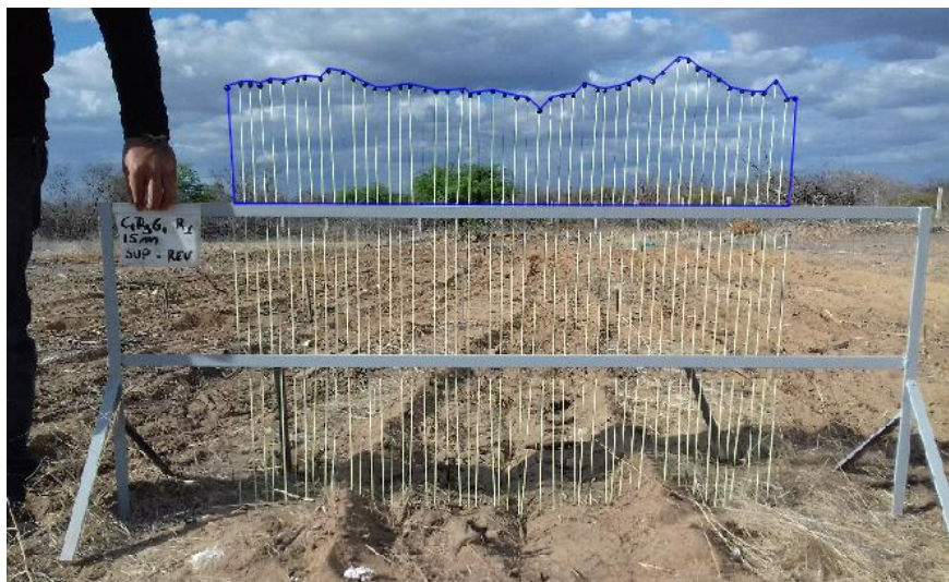
Figura 7 – Determinação do perfil superior do solo mobilizado utilizando o software AutoCad 2015.
