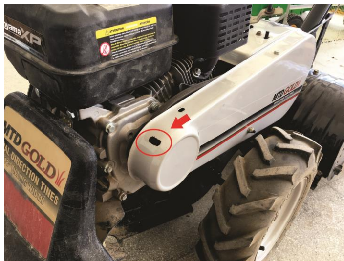
Figura 5 – Orifício confeccionado para posicionamento do fototacômetro.
