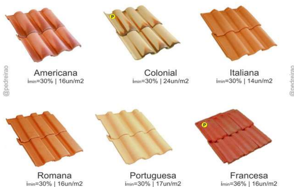
Figura 53 – Características das telhas cerâmicas
