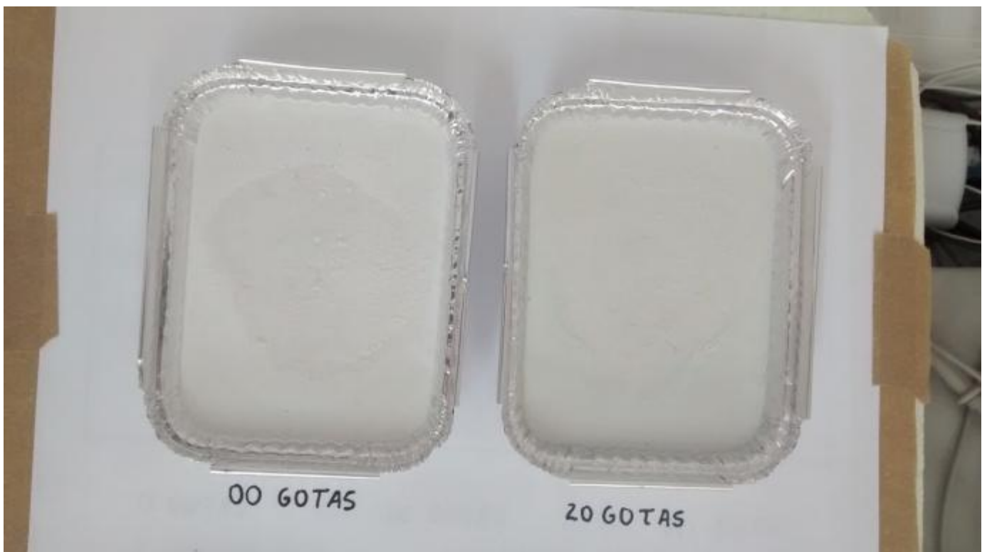
Figura 8 - Amostra de gesso com e sem indicador (1 hora).
