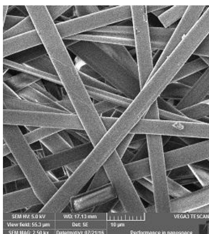
Figura 1. Microscopia eletrônica de varredura de fibras eletrofiadas de EDGT contendo Mn-EtOH na concentração de 100 mg.
