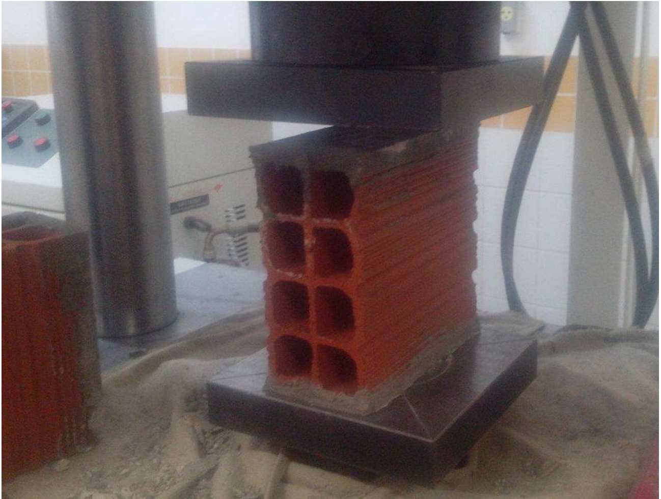
Figura 08: Ensaio de resistência a compressão dos blocos.
