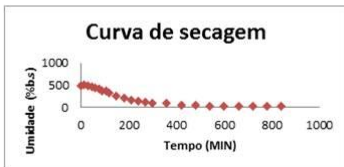
Figura 2 - Curva de secagem da manga desidratada em secador solar
