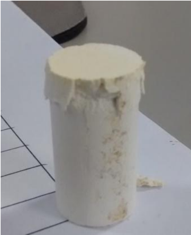
Figura 6 - Corpo de prova rompido no ensaio de resistência à compressão.
