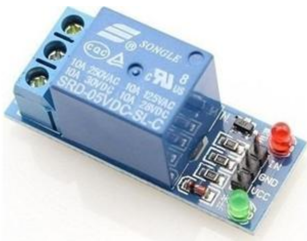
Figura 2 - Módulo relé acionado com sinal CC. Terminais de entrada à direita e de saída à esquerda.
