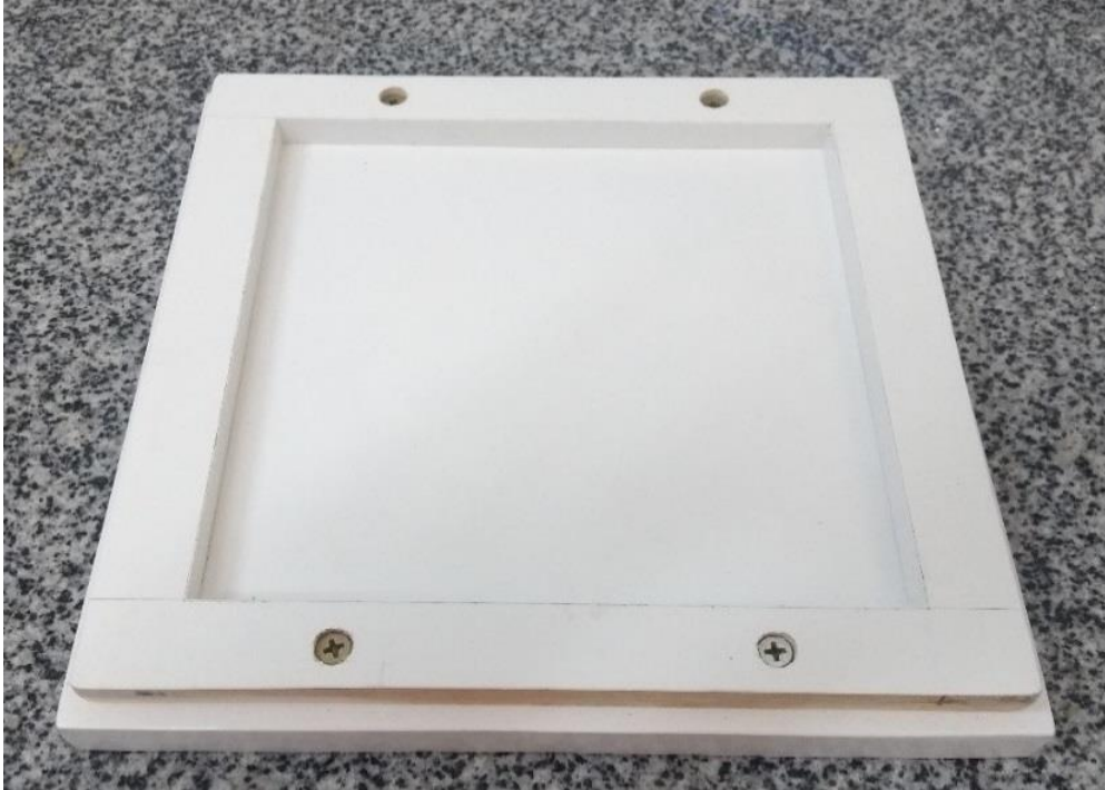
Figura 03: Molde para simulação de execução do revestimento de gesso.
