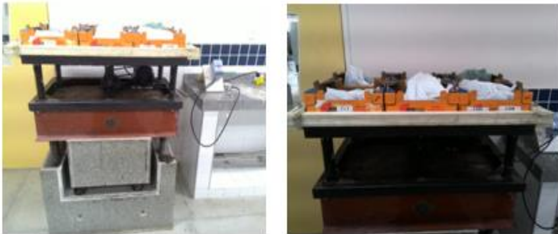
Figura 17 – Ensaio de vibração com caixas contendo 4 kg de areia.
