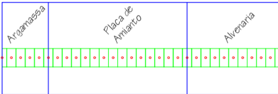
Figura 5 - Malha utilizada na aplicação do MDF no problema da parede do forno industrial.
