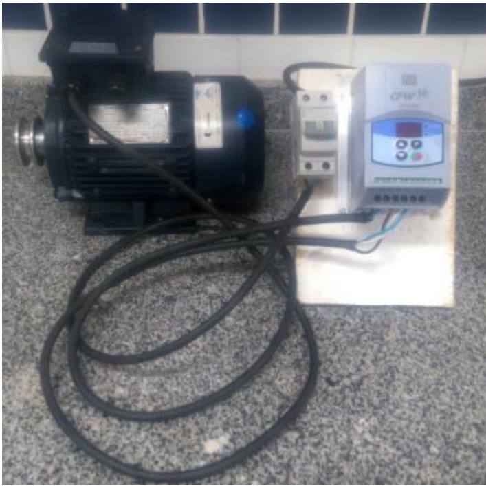
Figura 4 – Motor elétrico com acionamento por um inversor de frequência.
