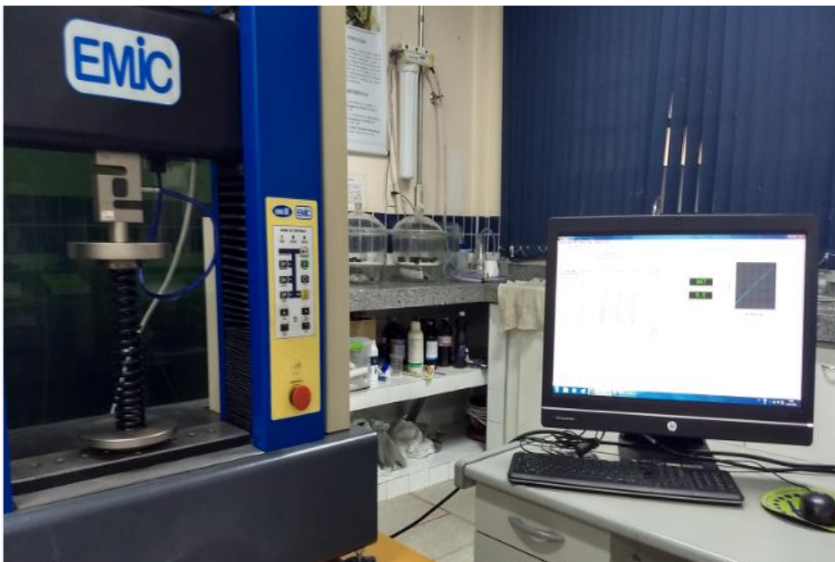
Figura 8 – Ensaio de compressão para determinar a constante de rigidez da mola.
