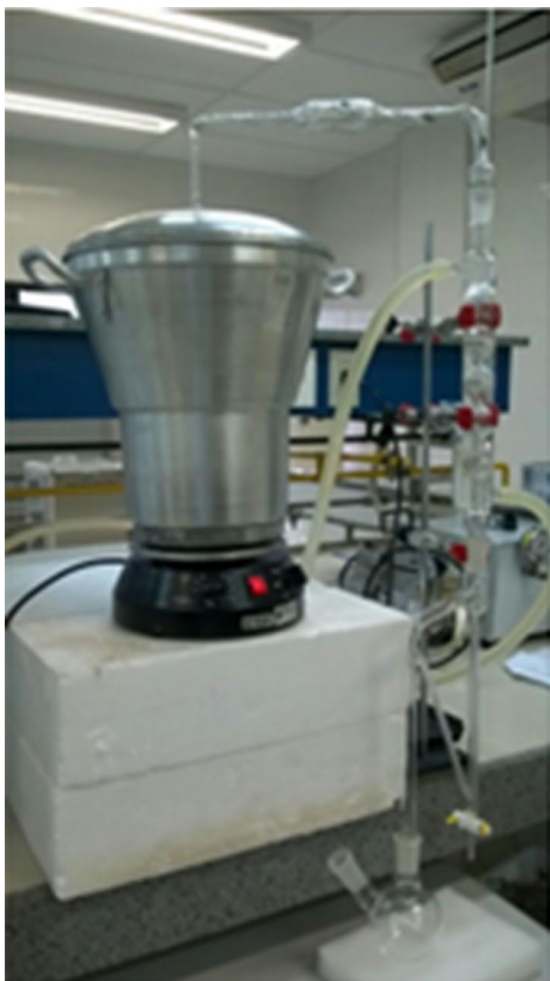
Figura 1. Aparelhagem para extração de óleos essenciais por arraste a vapor
