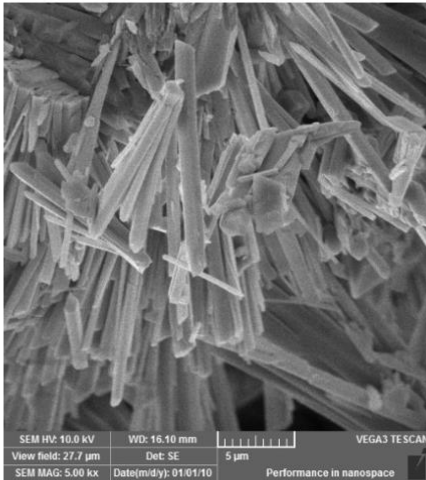
Figura 05: Micrografias do gesso hidratado com magnificação de 5000 vezes da região destacada na Figura 04.
