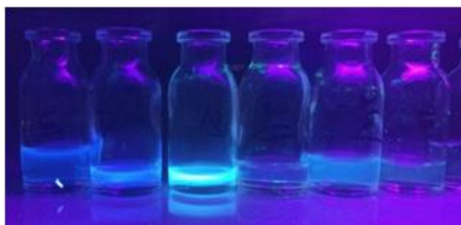
Imagem 9 – Frações separadas através de coluna cromatográfica de ( 6a ) que emitem fluorescência, reveladas em câmara UV a 365 nm. Fonte: Próprio Autor (2018).
